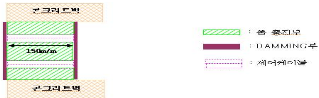
[그림 4-28] 시공방법3. 대형개구(수직) 충전부 측면도(X-X')
