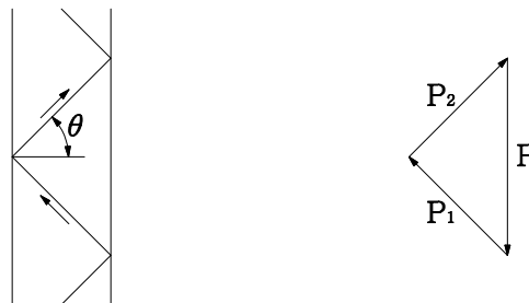
그림 21. 사재접속용 볼트의 응력
