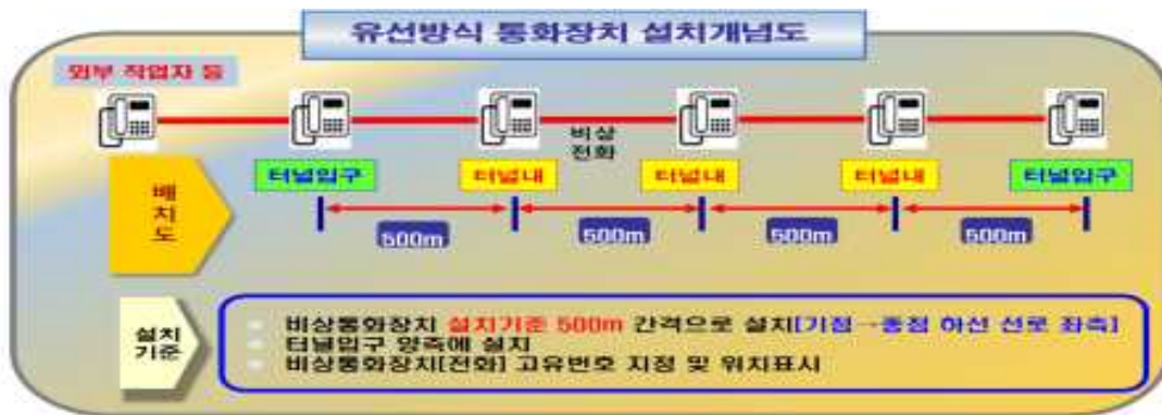
[그림 3-1] 유선방식 통화장치 설치 개념도
