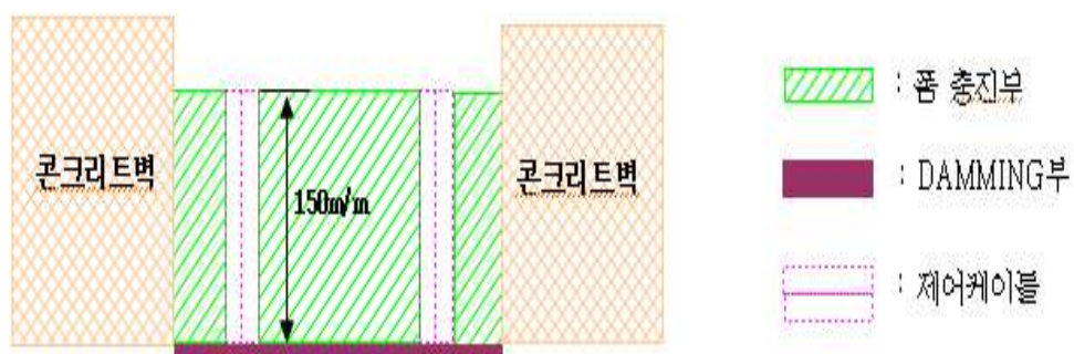
[그림 4-27] 시공방법2. 대형개구(수평) 충전부 측면도(X-X')
