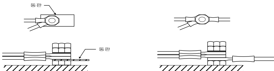
그림 5. 2회선 이상 설치
