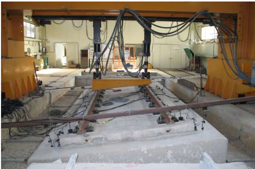
그림 4.1. 경사반복하중시험 개념도 및 시험 예시
