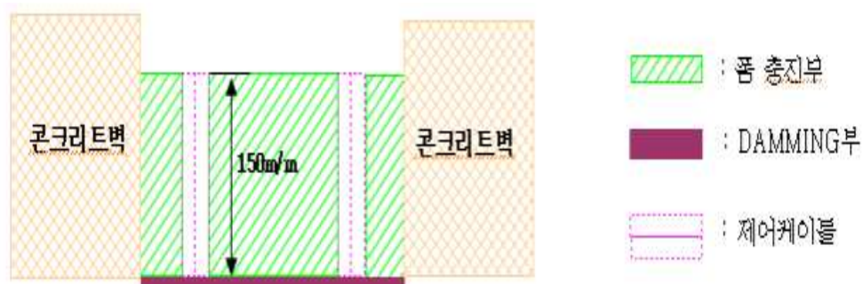
[그림 4-27] 시공방법2. 대형개구(수평) 충전부 측면도(X-X')
