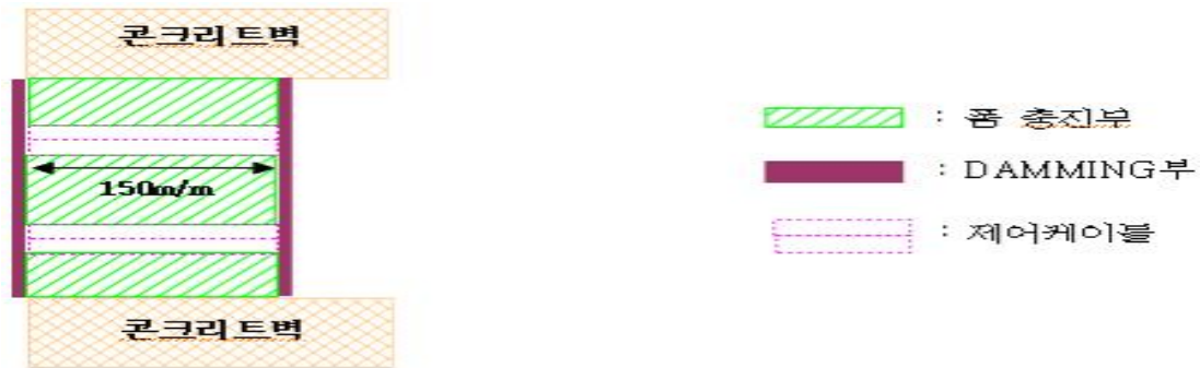
[그림 4-28] 시공방법3. 대형개구(수직) 충전부 측면도(X-X')
