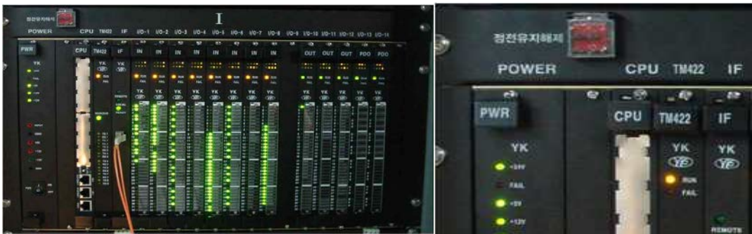
그림 142. 정전유지해제버튼 설치 위치
