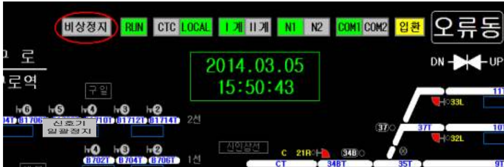
그림 143. 조작반의 신호기 일괄정지 표시
