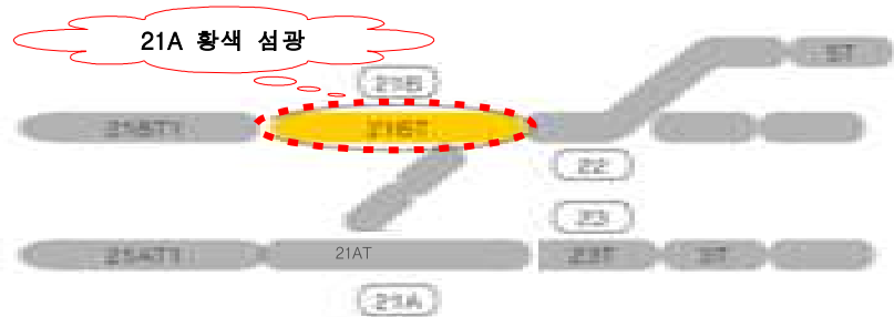
그림 115. 선로전환기의 불일치 표시
