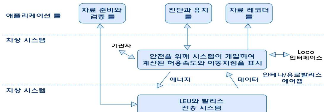
그림 15. ERTMS/ETCS 시스템의 구조
