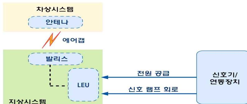
그림 16. 지상시스템 구조
