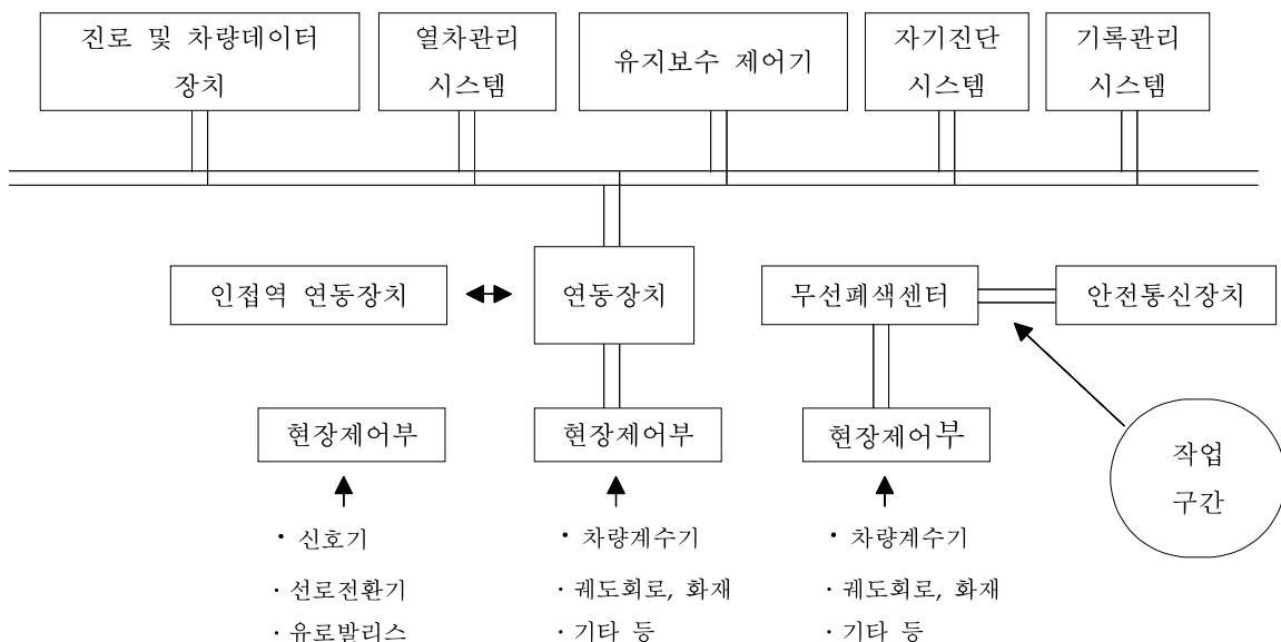
그림 8. ERTMS/ETCS 지상설비 구성
