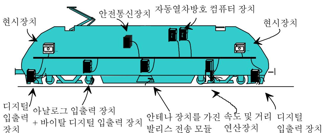
그림 9. 차내시스템의 분산설치(예)
