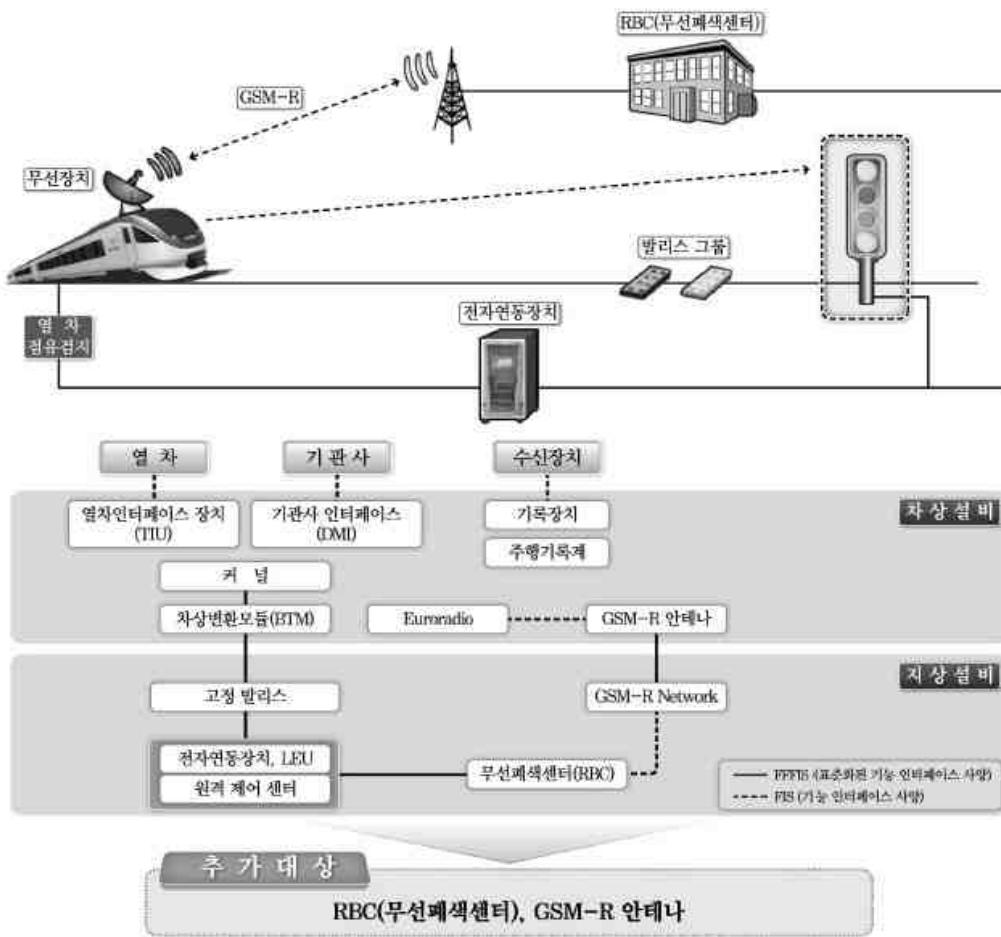
그림 3. ERTMS/ETCS Level 2 구성도
