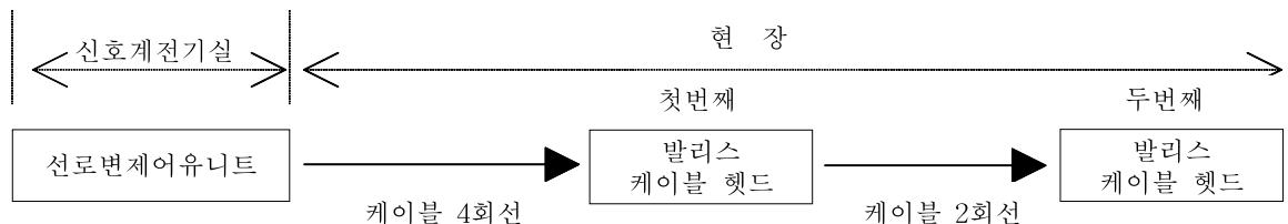
그림 14. 선로변제어유니트와 밸리스 단자함간 케이블 설치도
