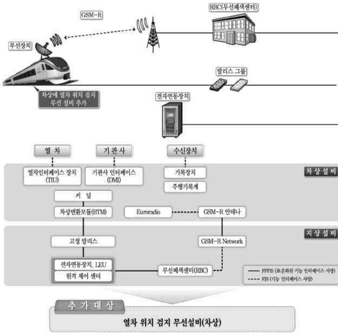
그림 4. ERTMS/ETCS Level 3 구성도
